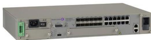
Рисунок 5-8. Внешний вид маршрутизатора RS7210
