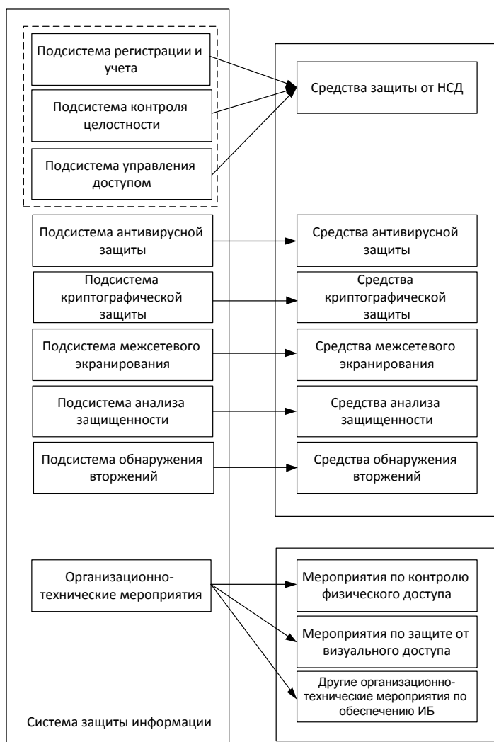
Рис. 2. Общая структура подсистемы обеспечения информационной безопасности
