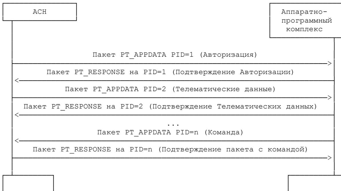
Рисунок А.3 - Взаимодействие АСН и аппаратно-программного комплекса на уровне пакетов транспортного уровня
